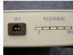
Uttag nätadapter och intern batteriindikator
